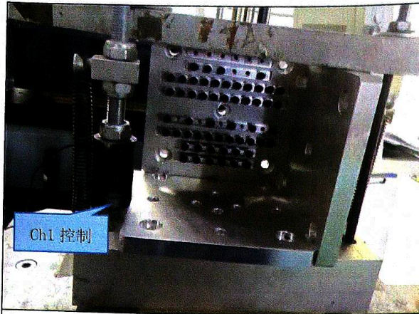
图 7: Z 向冲击试验实际安装状态
